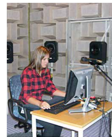
Ekofria rummet där deltagarna sitter och utför olika arbetsuppgifter i simulerade ljudmiljöer
